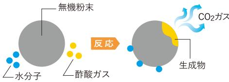
酢酸ガス分子は、球状粉末の表層部で反応して吸収分解される。
